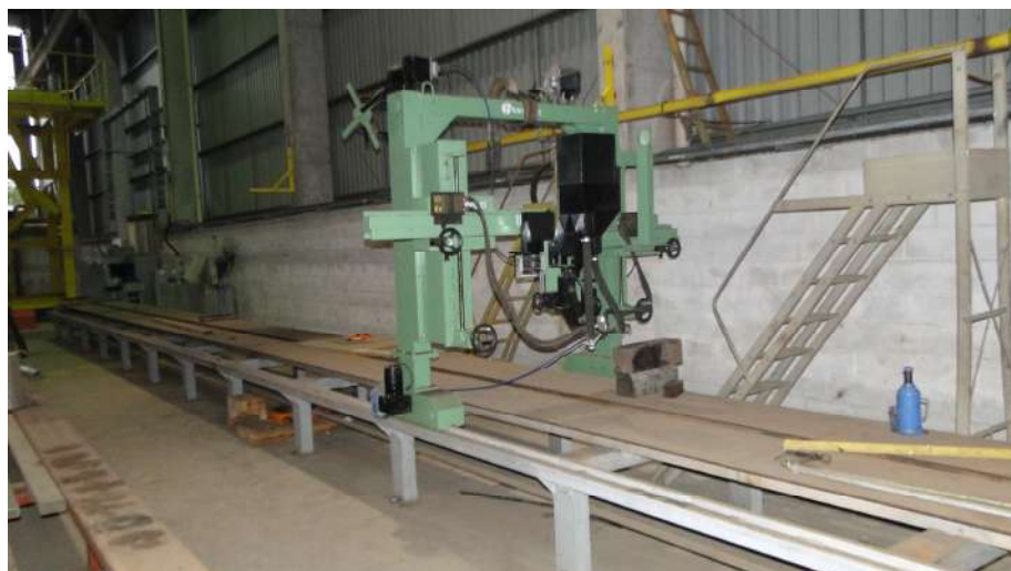
Foto 04: Máquina de arco Submerso para soldagem de vigas (item 203/204)
